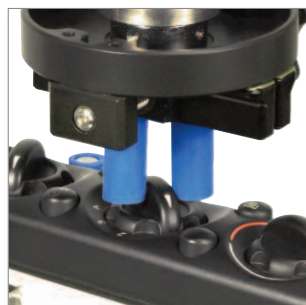
Test de mesure de couple sur un interrupteur rotatif dans l'industrie de l'automobile
