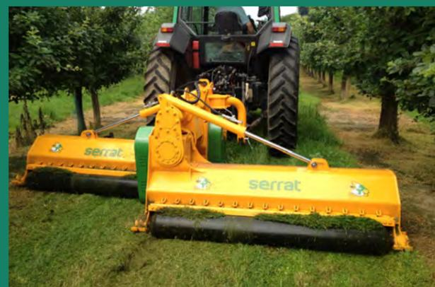
Ce broyeur permet de broyer en un seul passage le couloir qu'il y a entre les rangées d'arbres fruitiers ou les plantations intensives d'oliviers. Ce broyeur peut s'utiliser pour l'entretien des espaces verts ou des grands parcs, etc. Ce broyeur est composé d'une poutre centrale avec un système d'élévation des broyeurs par piston hydraulique. Courroies au centre du broyeur avec le latéral extérieur à 480 mm du sol pour accéder plus facilement au dessous des arbres.
