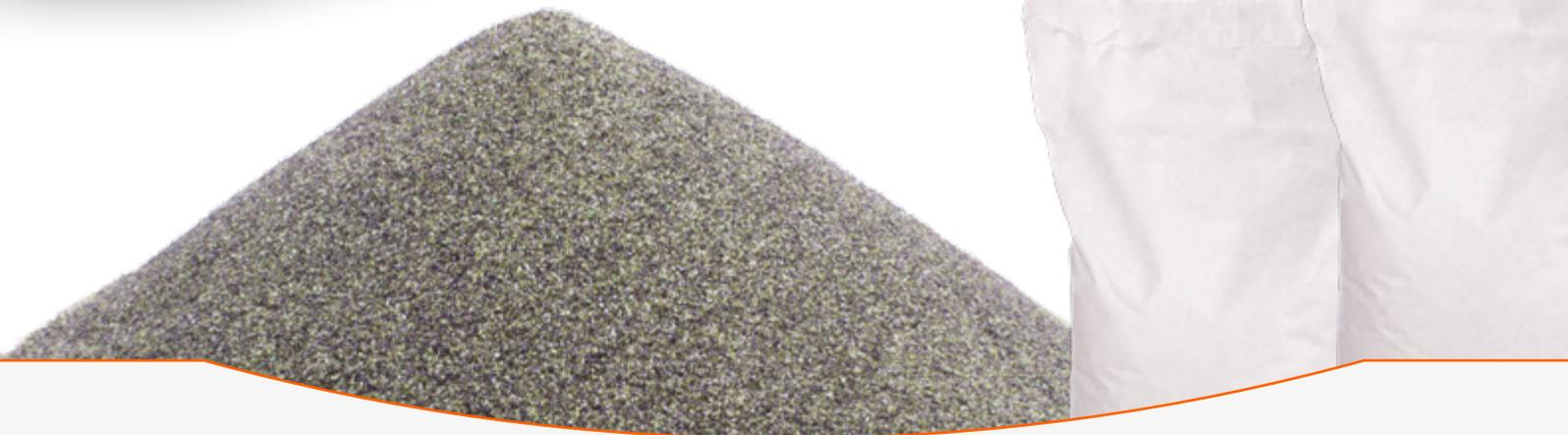
Le **NOVABLAST** est un abrasif angulaire conçu à partir de **silicate d'aluminium**, idéal pour les décapages résistants. Respectueux de l'environnement, il est conforme aux normes ISO. L'abrasif **NOVABLAST** est parfaitement utilisable dans le cadre de la pratique du décapage par aérogommage/sablage car il respecte un cahier des charges très précis lié à son utilisation.
