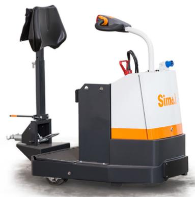
Tracteur à 3 roues, «homme à bord», avec traction avant. Extrêmement rapide, compact et maniable, idéal pour les services industriels à l'intérieur pour des petites charges sur des courtes distances:
