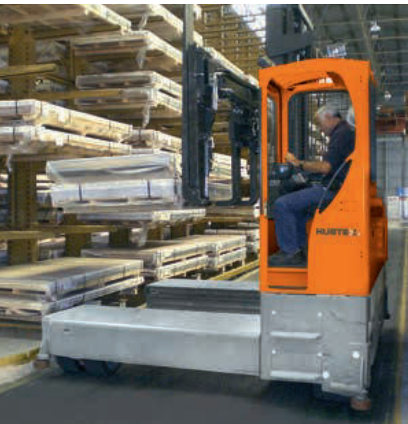
Chariot latéral multidirectionnel pour entrepôt de tôles d'aluminium Carrello elevatore laterale multidirezionale in magazzino di lastre di alluminio
