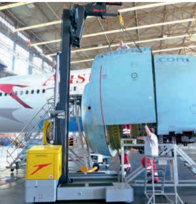
Chariot latéral multidirectionnel pour le montage de composants d'aéronefs Carrello elevatore laterale multidirezionale per il montaggio di componenti di aerei
