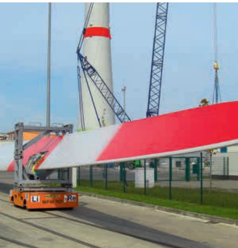
Chariot avec plateforme pour le transport de pales de rotor pour les éoliennes Piattaforma per il trasporto di pale per impianti eolici
