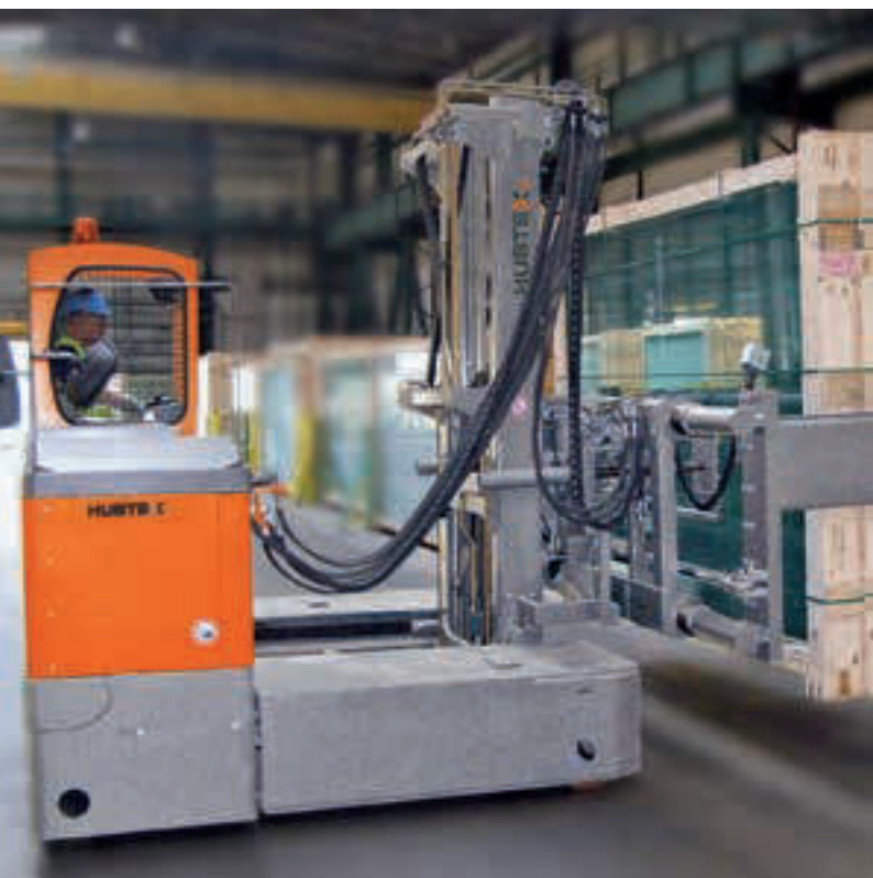
Chariot latéral multidirectionnel pour la réception de paquets de verre emballés Carrello elevatore laterale multidirezionale per vetro in pacchi imballati
