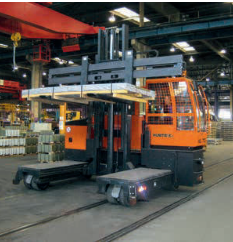
Chariot latéral multidirectionnel électrique avec cabine latérale Carrello elevatore laterale multidirezionale elettrico con cabina laterale
