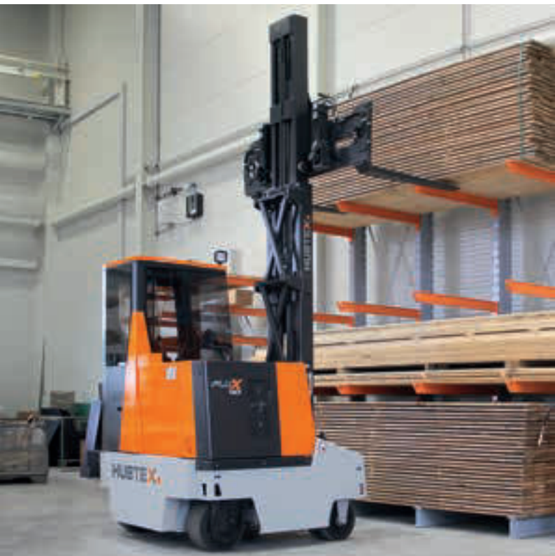
Chariot latéral multidirectionnel lors de la maintenance de panneaux agglomérés Carrello elevatore laterale multidirezionale per la movimentazione di pannelli truciolari
