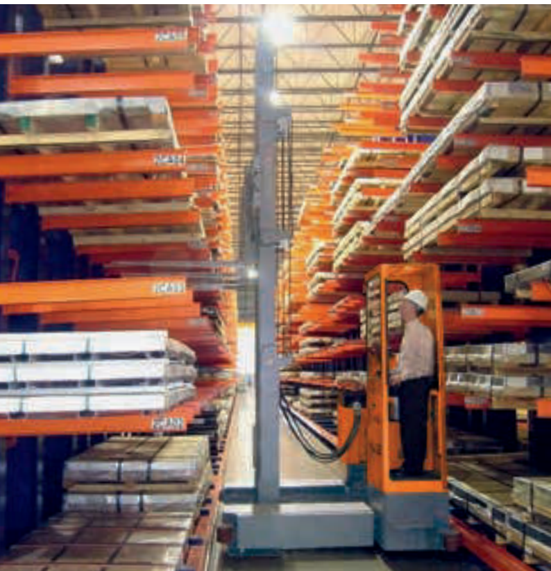
Chariot latéral multidirectionnel pour le stockage de tôles Carrello elevatore laterale multidirezionale in magazzino di lamiera
