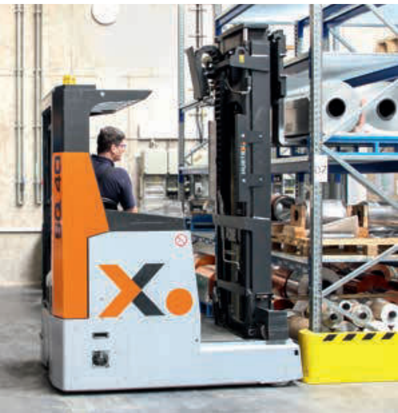
Chariot tridirectionnel compact à mât rétractable Carrello elevatore retrattile compatto
