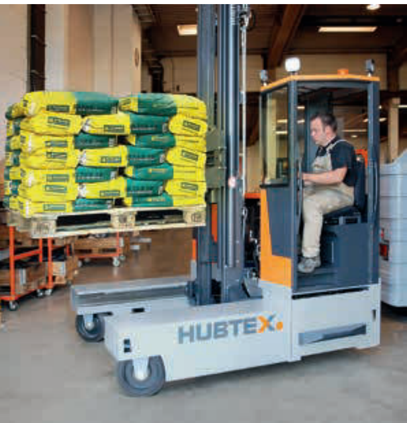
Chariot latéral multidirectionnel compact pour grandes surfaces de bricolage Carrello elevatore laterale multidirezionale compatto impiegato in centri Fai Da Te
