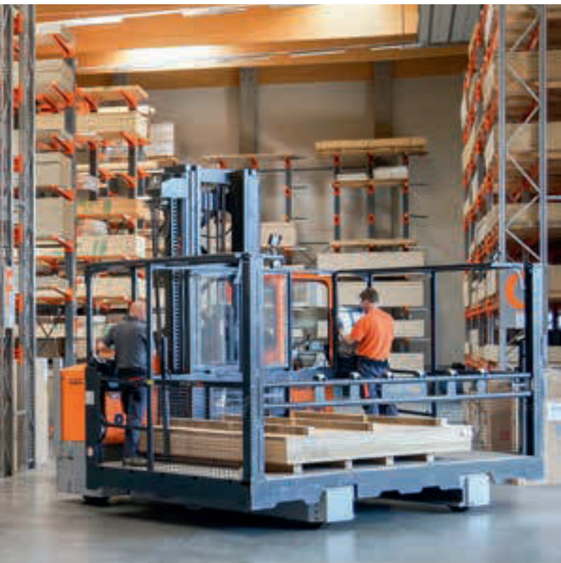
Chariot latéral multidirectionnel avec plateforme de préparation de commandes amovible
