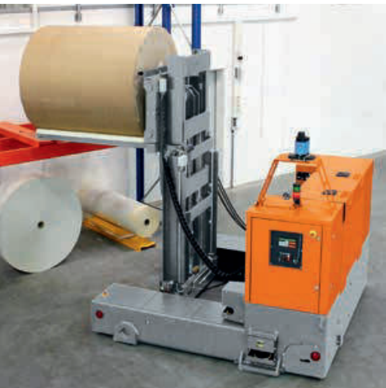
Système de transport sans conducteur pour la manutention de rouleaux Sistema di trasporto senza conducente per la movimentazione di bobine
