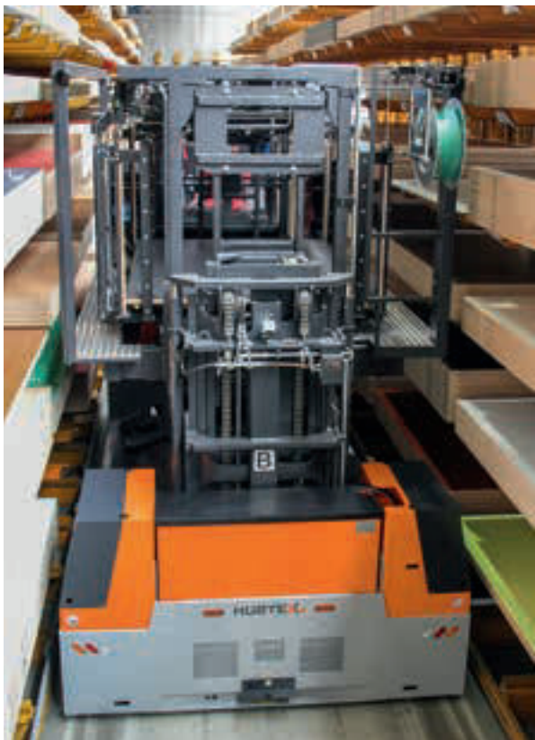
Préparation de commandes avec système ventouses Sistema Vacumat per il picking di pannelli
