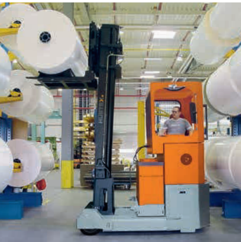
Chariot à mât rétractable pour la manipulation de rouleaux de papier, capacités 3,5 – 6 t
