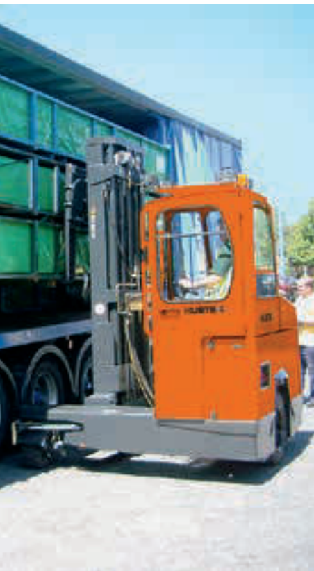
Chariot élévateur quadri-directionnel avec diesel ou gaz Carrello elevatore quattro vie con motore diesel o GPL
