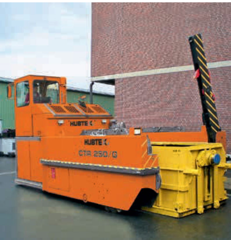
Transporteur pour conteneur à déchets, capacité jusqu'à 50 t Trasportatore per contenitore di rottami, portata fino a 50 t
