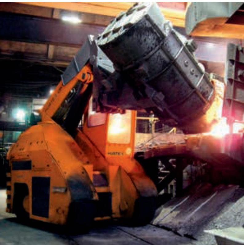
Chariot compact à bras télescopique pour la manipulation de charges de chaleur extrême
