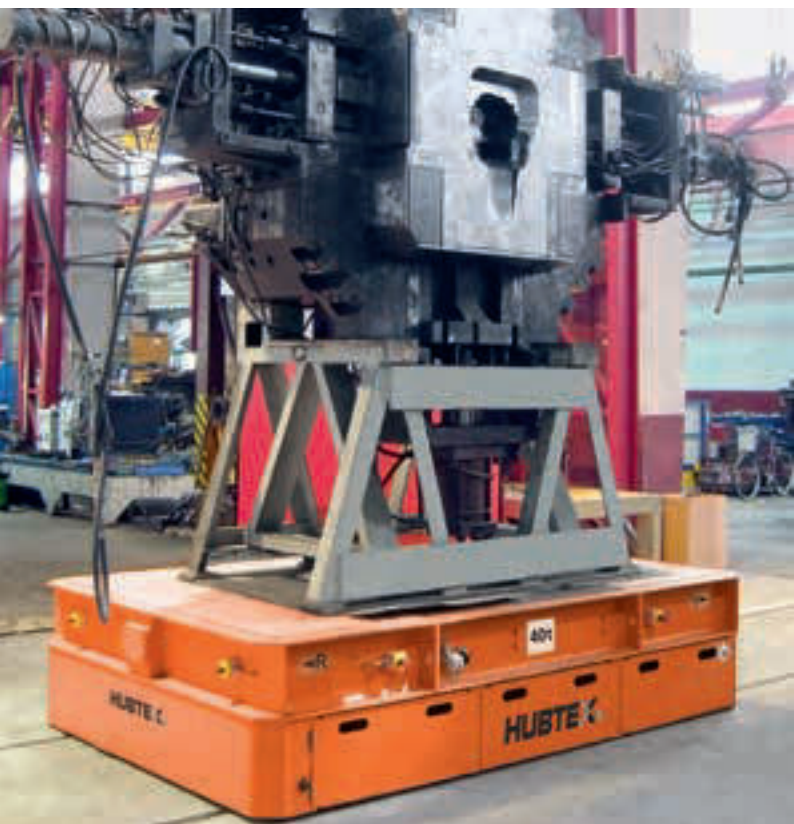
Chariot à plateforme, capacités de 10 – 63 t Piattaforma, portate da 10 – 63 t
