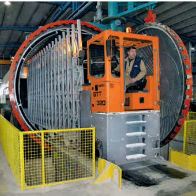
Chargement et déchargement des bâtis de verre sur une installation autoclave Movimentazione di cavalletti per vetro in un sistema autoclave
