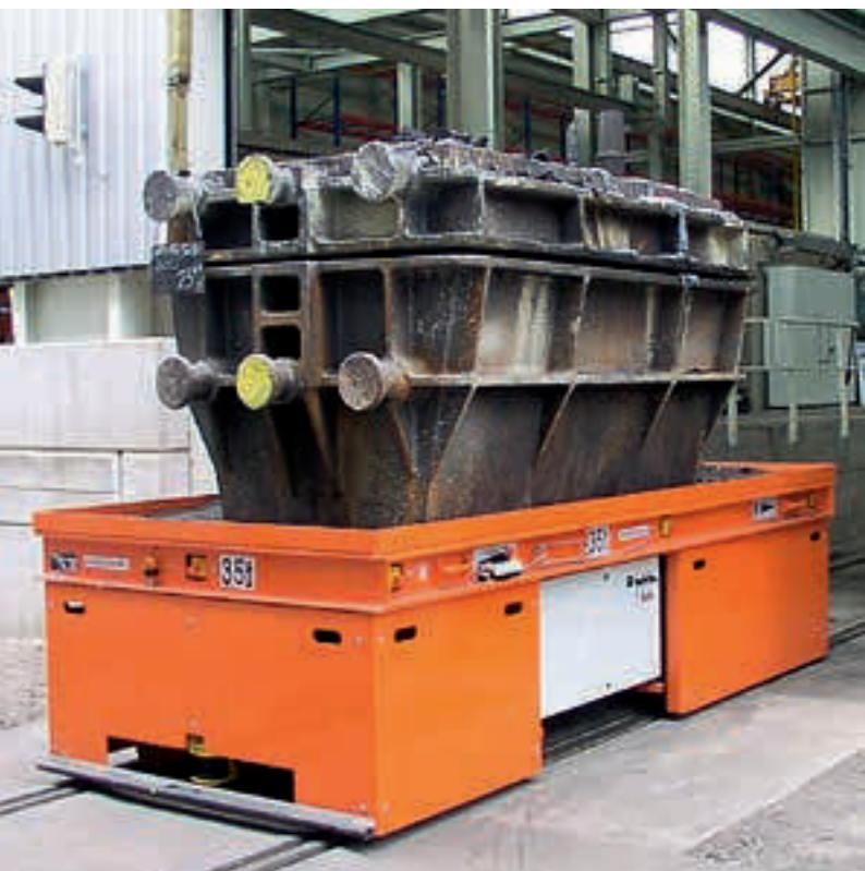
Chariot sur rail pour le transport de moules de coulage Carrello su rotaia per il trasporto di stampi da fonderia
