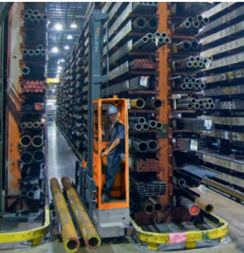
Chariot latéral multidirectionnel en allée étroite Carrello elevatore laterale multidirezionale in corridoio stretto
