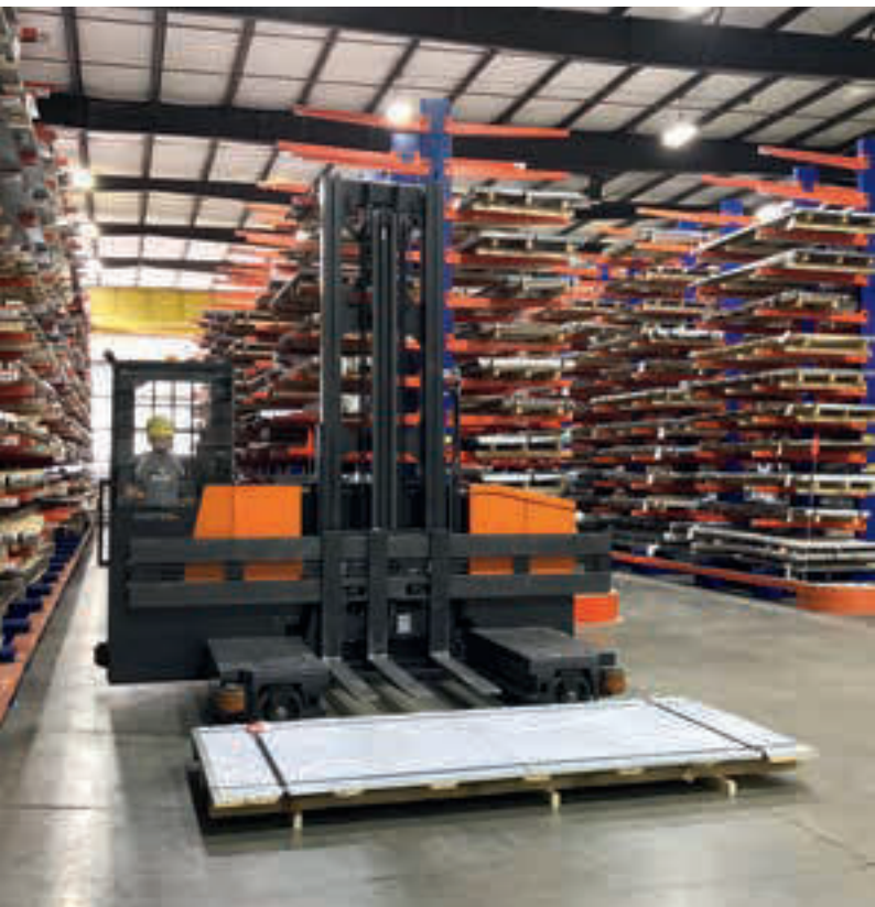
Chariot multidirectionnel électrique avec accès à la cabine de faible hauteur Carrello elettrico multidirezionale con soglia di accesso vicina al suolo
