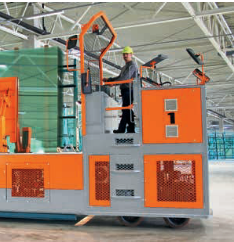
Transpupitre avec énergie électrique, diesel et/ou gaz Trasportatore di cavalletti per vetro con motore elettrico, diesel o a gas
