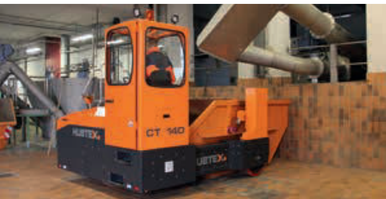
Transport de cuves avec harnais de levage ou bras de fourches Movimentazione di cassoni con sistema di sollevamento e ribaltamento
