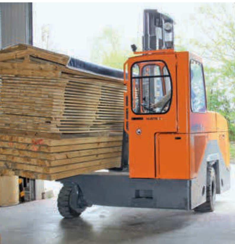
Chariot latéral quadri-directionnel, capacité 6 – 8 t Carrello elevatore laterale multidirezionale, portata 6 – 8 t
