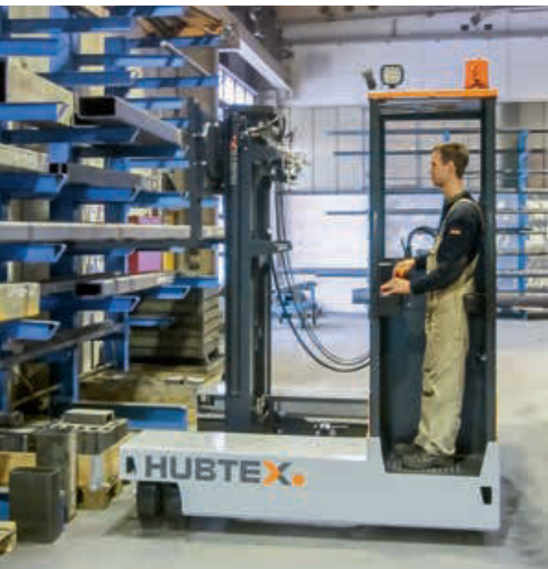
Chariot latéral multidirectionnel électrique en version trois roues Carrello elevatore laterale multidirezionale elettrico a tre ruote
