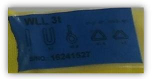
L'impression de l'étiquette contient les informations suivantes : charge nominale d'utilisation (WLL) en tonnes ou en kilogrammes et la plage d'angle correspondant, le code de traçabilité, la matière utilisée, la longueur utile EWL, le nom du fournisseur, la date de fabrication, le marquage CE et numéro de la norme harmonisée : 1492-2-2000+A1:2008.
