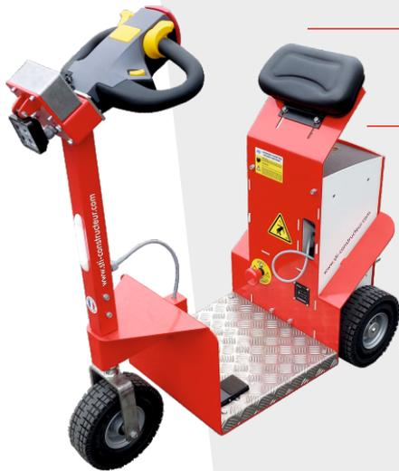
Capacité de traction : 700 kg sur terrain plat
