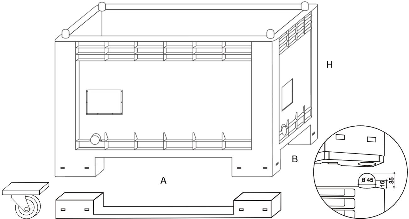
Le CARGOPALLET 300 PLUS est versatile et robuste, a une bonne rigidité structurale, résiste à la déformation. Idéale pour l'industrie textile, pharmaceutique, métallurgique et mécanique, du traitement du caoutchouc et des matières plastiques.
