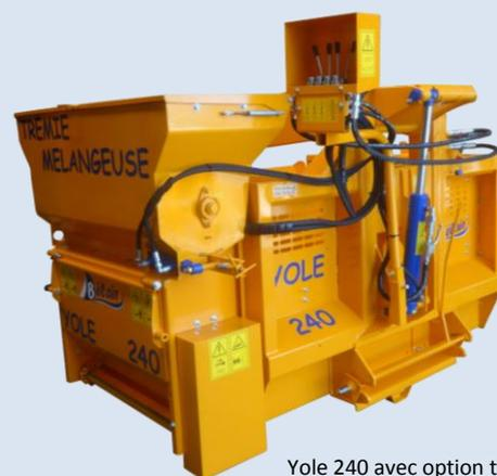
Yole 240 avec option trémie et rehausse trémie
