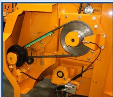
1/ Entraînement du démêleur par chaîne = fiabilité et puissance (embrayage en option)
