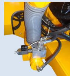
*Vis de distribution avec régulation électrique*
