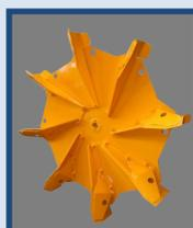
Turbine de 1,60 mètre de diamètre composée de 8 pales boulonnées
