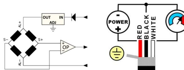
Câble blindé en PVC 70°C, Ø 4,2mm 4 fils Ø 0,14mm<sup>2</sup> étamé. Blindage connecté au corps du capteur
