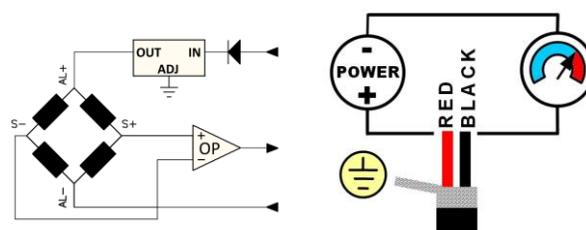
En sortie amplifiée 0.5V, 5V, 10V
