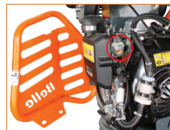
Carburateur avec système d'amorçage. Moteur avec sécurité d'huile Protections moteur amovibles
