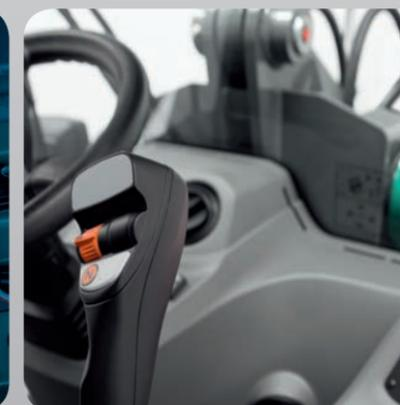
**Pilotage réactif et précis** de la machine et des équipements au moyen d'un joystick à commande pilote.
