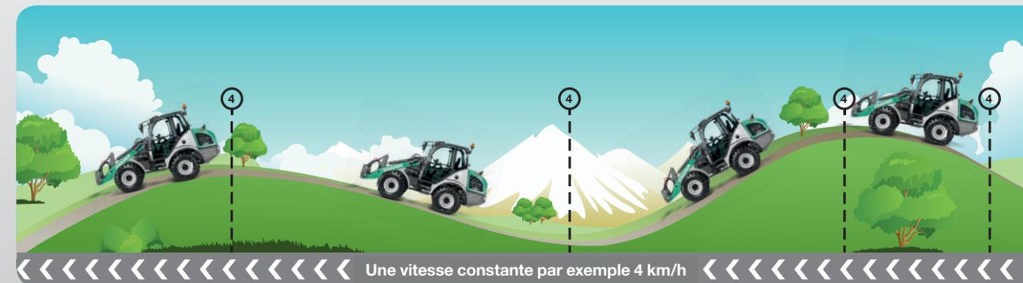
Lors de l'utilisation d'équipements spéciaux, qui doivent être par exemple utilisés avec un régime moteur élevé et constant mais également à très faible vitesse de déplacement (par ex. une balayeuse), ces paramètres de conduite peuvent être réalisés
