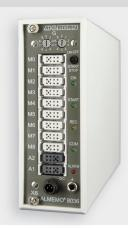
Appareil de mesure de référence pour la température et l'humidité. Appareil de mesure multicanal à 9 entrées de mesure pour capteur Pt100 et psychromètre Pt100. Mesure ultra-précise de résolution 0,001 K Pour labo d'étalonnage, assurance qualité, surveillance de chambres de mesure. Fonctionnement comme interface PC ou avec connecteur mémoire externe, comme centrale d'acquisition.
