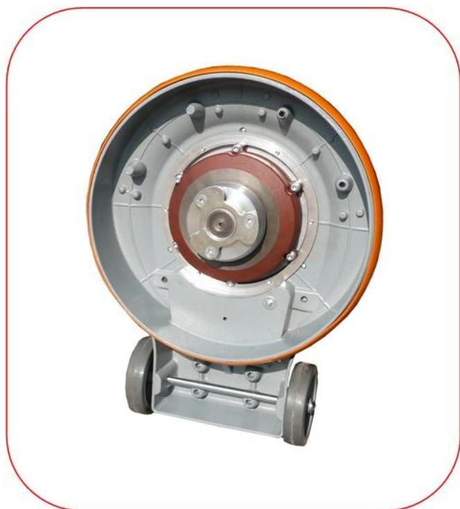
Groupe réducteur monté sur 3 engrenages planétaires avec dents hélicoïdales en acier trempé, associés à des roulements surdimensionnés pour la durée dans le temps.
