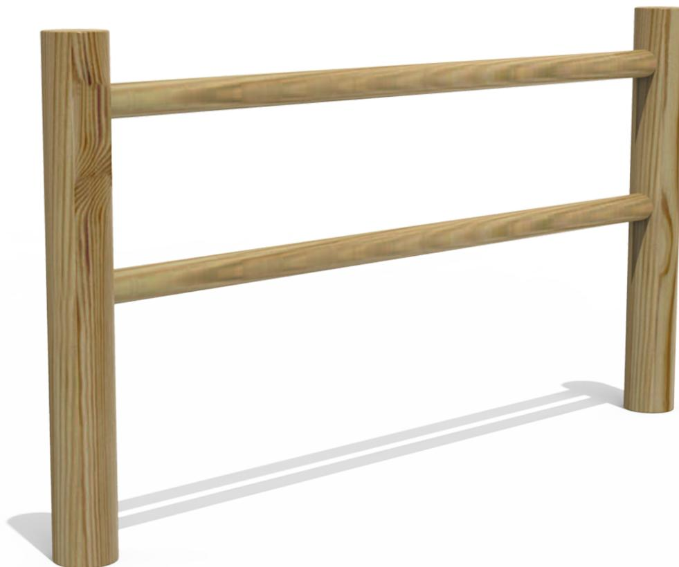
Barrière en bois de pin traitée en autoclave vide et pression classe IV contre les vrillettes, termites et insectes. Poteaux de Ø 120 x 1500mm. Traverses de Ø80 x 2000 mm.
