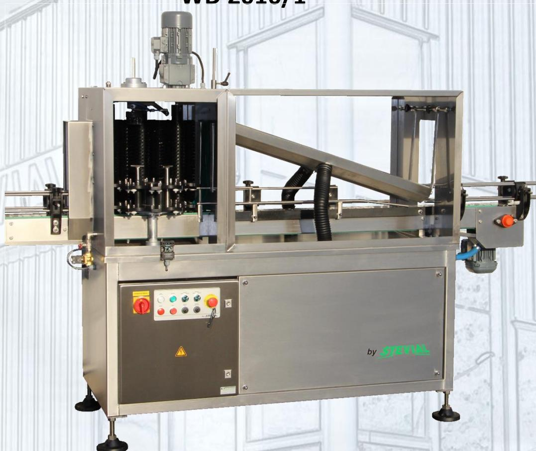
Idéale pour un **lavage et séchage parfaits** de tous types de bouteilles jusqu'à **1500 bouteilles par heure**.
