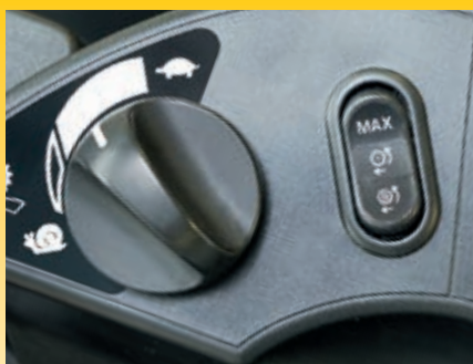
Commande de changement de vitesses variable avec nouvelle plage de vitesse d'approche lente (gauche) et commutateur de limiteur de couple (TCS) variable (droite)
