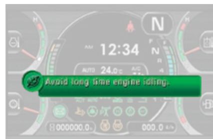
Les conseils éco prennent en charge les économies d'énergie en temps réel (p.ex. éviter les phases au ralenti prolongées)
