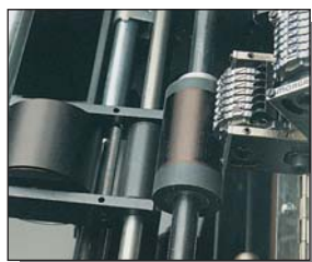
Système de numérotation rotatif
