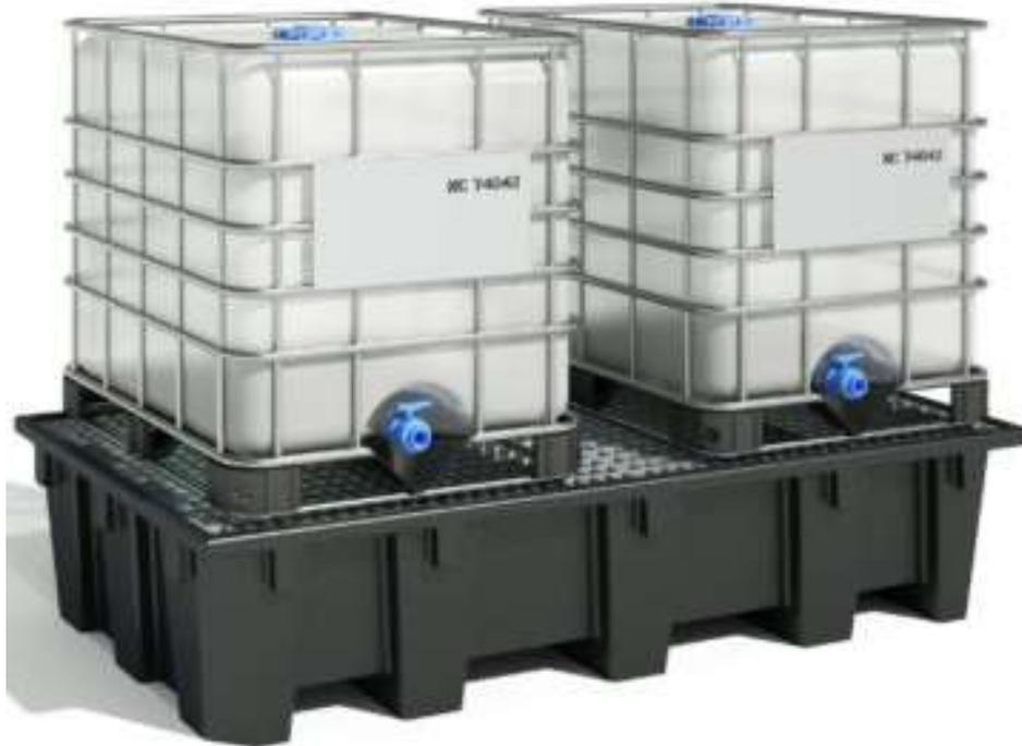
Les bacs de rétention en plastique sont particulièrement adaptés aux acides et bases. 100% polyéthylène avec un caillebotis en acier galvanisé, ils regroupent de nombreux avantages : légèreté, facilité de nettoyage, longévité, résistance à la corrosion et aux produits chimiques. Le bac de rétention BAC2C/ECOG est adapté au stockage de 2 cuves de 1000 litres ou de 8 fûts.
