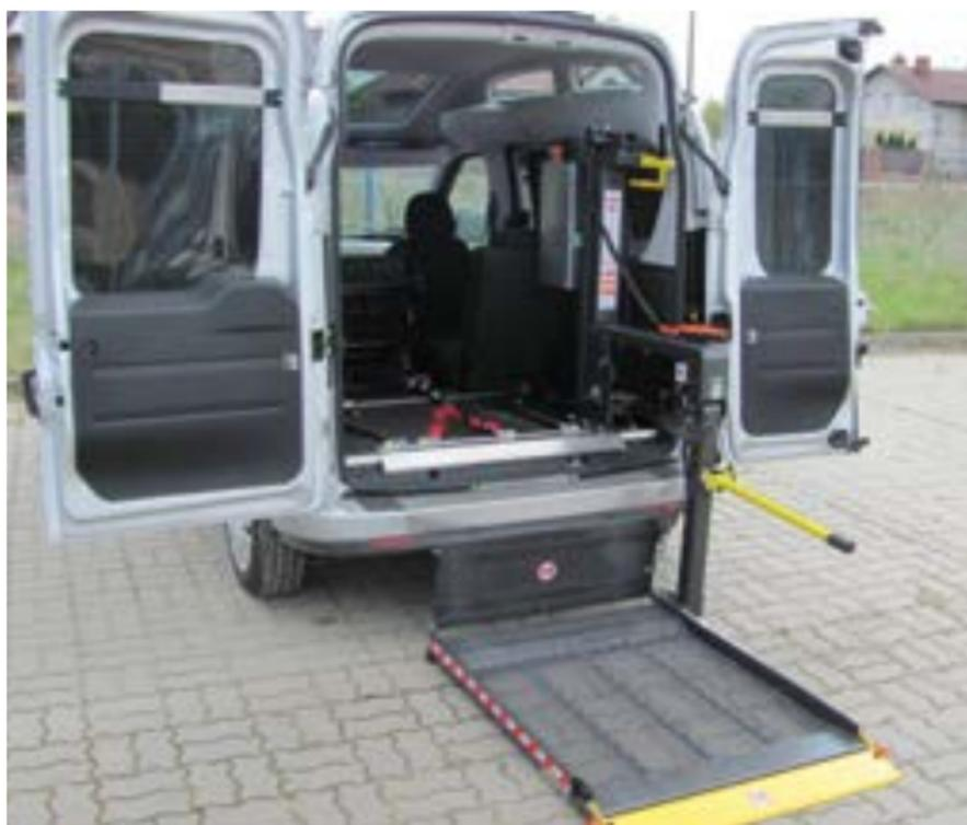
Le DH-PH1.03 est un **élévateur à un bras**, adapté pour un montage soit à l'intérieur, soit au niveau de portes arrières ou latérales d'une large gamme de véhicules de tourisme, minibus et ambulances.
