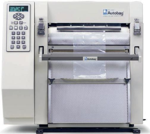
Les ensacheuses de table Autobag® PaceSetter PS 125™ et PS 125 OneStep™ sont spécialement conçues pour que les applications d'ensachage à chargement manuel gagnent en simplicité, en souplesse, en qualité et en valeur ajoutée.
