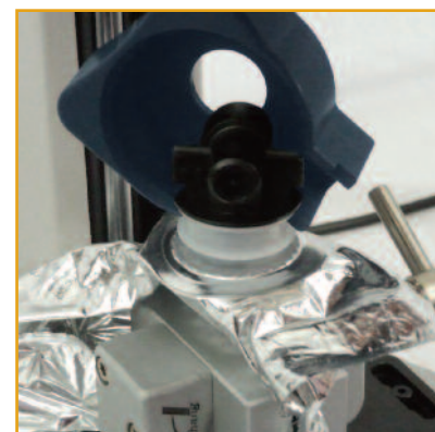
Test de traction sur le joint d'étanchéité
