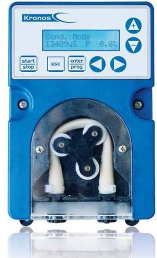
La **pompe doseuse Kronos de contrôle de conductivité** est conçue pour deux fonctions de base: Ouverture d'une électrovanne (Fonction déconcentration) par retour de la mesure de conductivité et dosage proportionnel par entrée d'un signal volumétrique donné par un compteur d'impulsions, pour résoudre quatre problèmes importants sur l'application des tours aérorefrigérentes:
