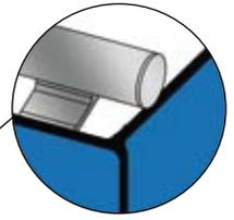
L'ajustement de la façade se fait par un bandeau en aluminium laqué de 45mm de diamètre qui assure solidité et rigidité. Fixé en retrait, à l'intérieur des cabines, le bandeau est maintenu par 2 supports aluminium sur chaque meneau. Un jonc PVC et un cache sur les côtés apportent une esthétique agréable au niveau du passage de porte.
