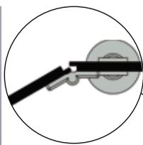
Les portes sont posées en feuilure sur les meneaux pour un affleurement total de la façade et une finition esthétique irréprochable. Leur ouverture peut être intérieure ou extérieure.
