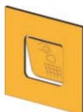
Usinée dans le fond de cabine, elle permet de jeter directement les déchets dans les poubelles placées dans une galerie technique entre deux blocs sanitaires.
