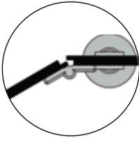
Les portes sont posées en feullure sur les meneaux pour un affleurement total de la façade et une finition esthétique irréprochable. Leur ouverture peut être intérieure ou extérieure.
