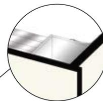
L'ajustement de la façade est assuré par une poutre bandeau en aluminium laqué. Elle se fixe par une équerre sur un poteau d'appui disposé tous les 4,50m. En partie basse, une embase réglable permet la mise à niveau de la poutre. Pour une stabilité et une rigidité totale, les meneaux et impostes sont assemblés par 2 supports aluminium.
