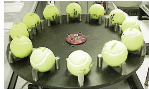
Carrousel de chargement de balles de tennis utilisé avec un banc d'essai Mecmesin
