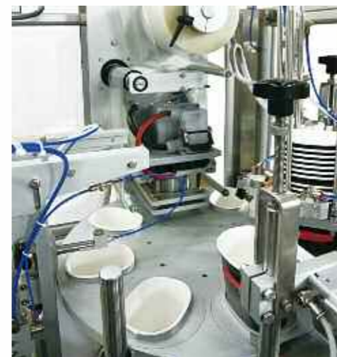
Stazione di dosaggio / Doser unit
