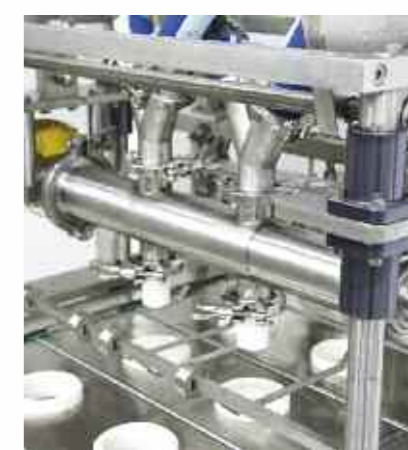
Stazione di dosaggio/Doser unit
