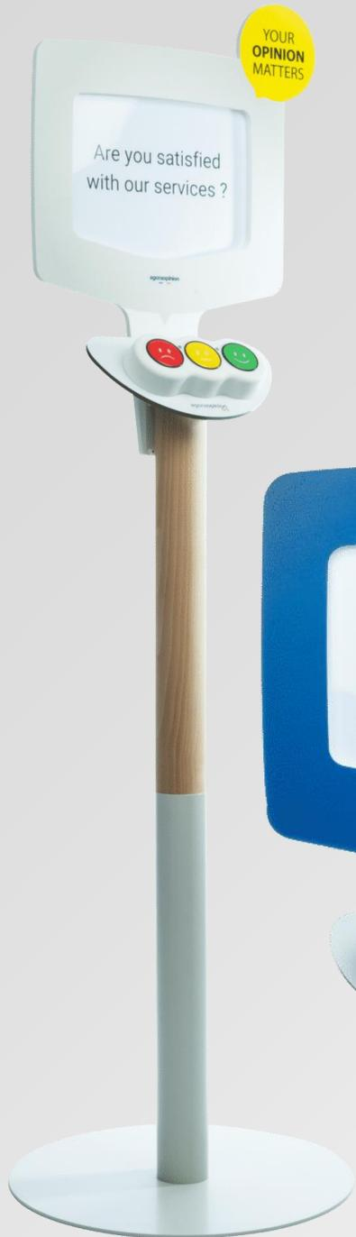
OPINYON est un boîtier de satisfaction autonome en énergie et communiquant sans fil via des réseaux indépendants (GSM, Sigfox, LoRaWan).
