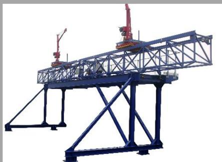
Ossature mécano-soudée de grandes dimensions
