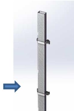
3- Engager la ceinture du panneau sur les 2 pinces de la fixation supérieure (4), puis procéder au serrage final des vis pré-montées (5).
