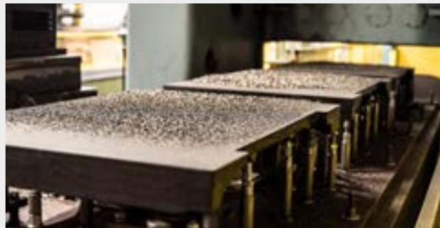
Rectification d'une table en fonte
