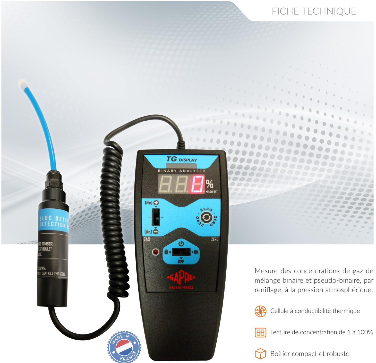
Mesure des concentrations de gaz de mélange binaire et pseudo-binaire, par reniflage, à la pression atmosphérique.
