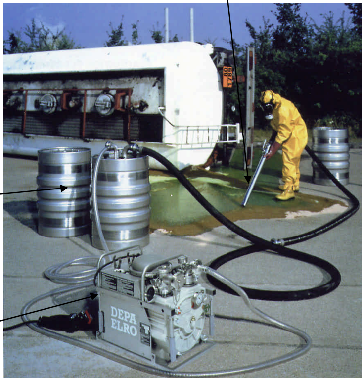
Canne d'aspiration Inox diam. 50 mm
