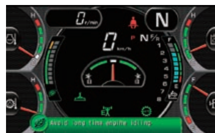
Les conseils éco prennent en charge les économies d'énergie en temps réel
