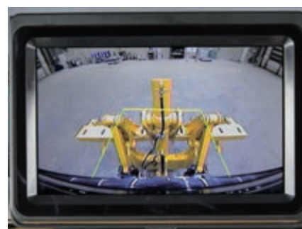
Système de caméra vue arrière complètement intégré
