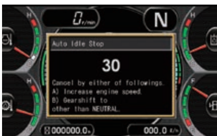
Arrêt moteur automatique réglable en cas de ralenti prolongé
