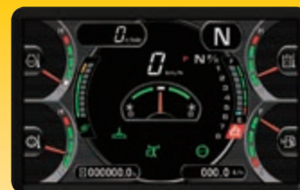
Assistance à la vérification du niveau du liquide AdBlue®
