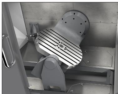
La table sur berceau à deux axes intégrée du UMC-750 positionne les pièces à quasiment n'importe quel angle pour l'usinage sur cinq faces ou offre un mouvement 5 axes simultané pour les opérations de contournage et d'usinage complexe.
