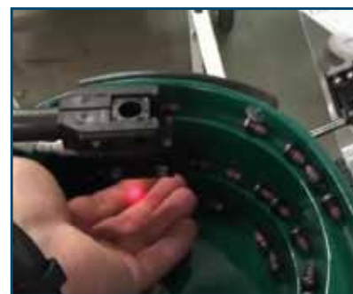
Alimentation avec capteur spécial "bol vide" , un dispositif qui signale lorsque le bol vibrant doit être rechargé des vis (sur demande).
