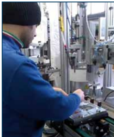
Exemple de système avec broche électrique asservie sur ligne de production.
