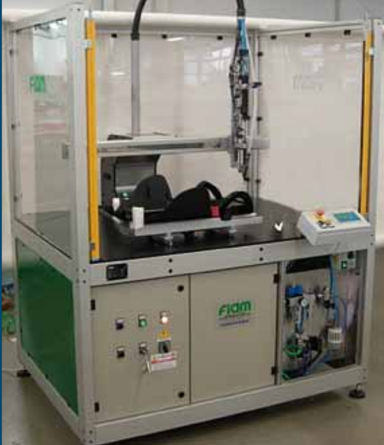
Intégration de MCA sur des machines existantes, par exemple avec des axes électriques XY cartésienne
