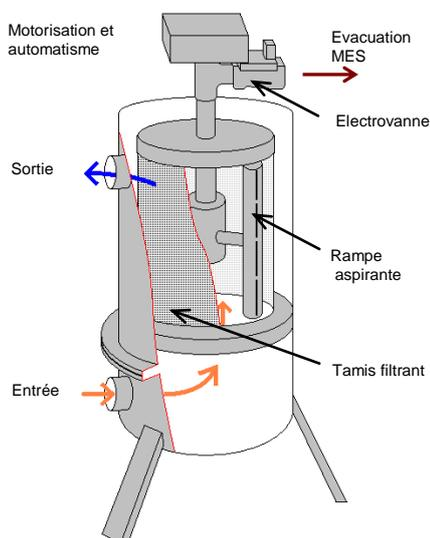
**Filtration.** La filtration s'effectue au travers d'un tamis cylindrique. Lorsque ce tamis est colmaté, un pressostat détecte le différentiel de pression entre l'entrée et la sortie et déclenche le cycle de nettoyage.
