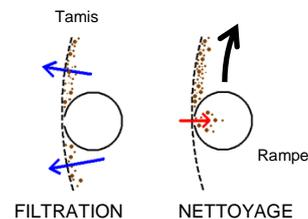
**Evacuation.** Lors du nettoyage, une électrovanne s'ouvre et les matières en suspension sont évacuées en dehors du filtre.
