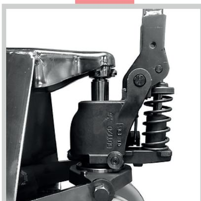
Timon facile à assembler avec un système de montage rapide grâce à deux joints entièrement soudés qui assurent une résistance accrue dans n'importe quelle application.
