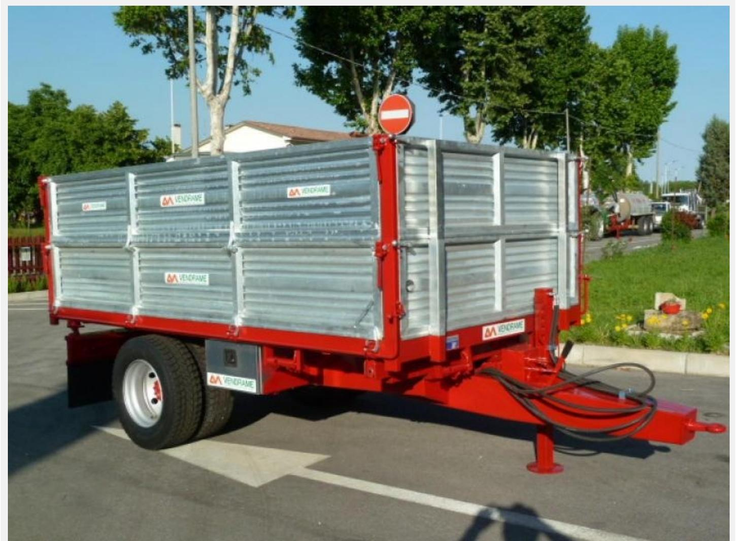
Remorque agricole, caisse 350x200, homologation routière 6.000 kg, freinage hydraulique, ouverture haut et bas ridelle postérieure, essieu moteur, pneumatiques 245/75-17.5.
