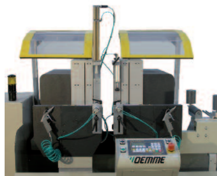
L'utilisation d'un moteur sans balai avec capteur sur bande magnétique garantit une rapidité et une précision très élevée de positionnement de la tête mobile
