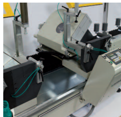
La partie frontale est équipée d'un large bassin de recueil copeaux et les guides sont protégées par un soufflet
