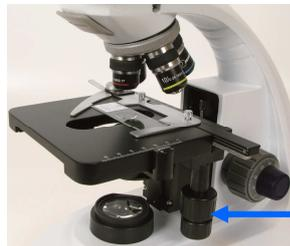
Placer délicatement la lame à observer en la glissant sur la platine, lamelle vers l'objectif. La maintenir avec la pince du guide-objet.
