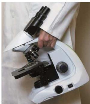
Avant de déplacer votre microscope, s'assurer que les oculaires soient bien fixés dans leur tube oculaire. Saisir le microscope d'une main par le haut du microscope.
