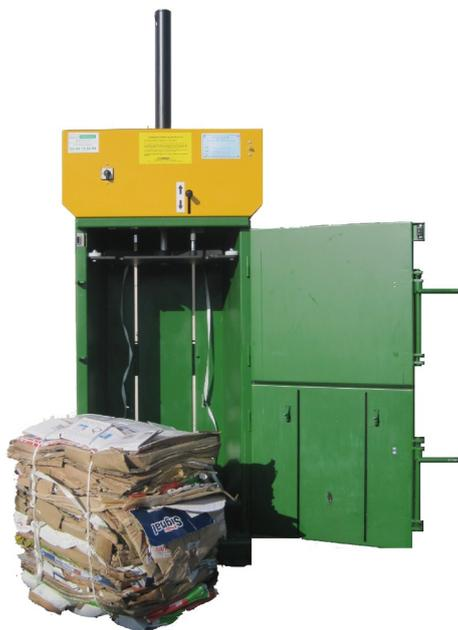
Le remplissage de la chambre de compactage est facilité par un volet de chargement à hauteur d'homme.
