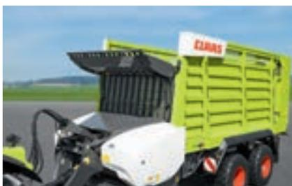
Tôle de chargement hydraulique
