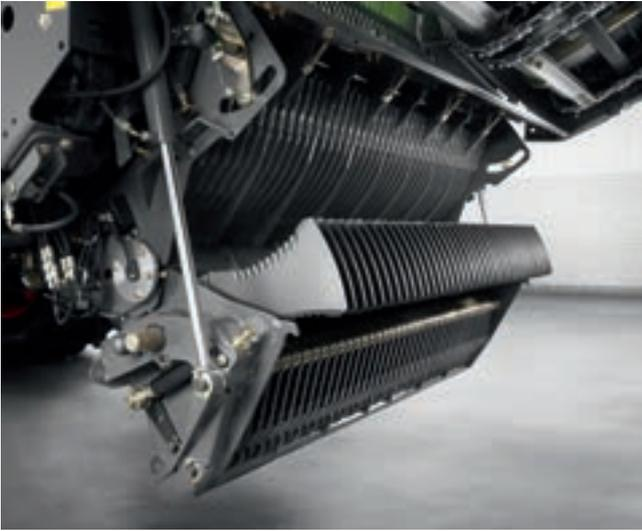
Remplacement simplifié des couteaux grâce au porte-couteaux pivotant hydrauliquement.
