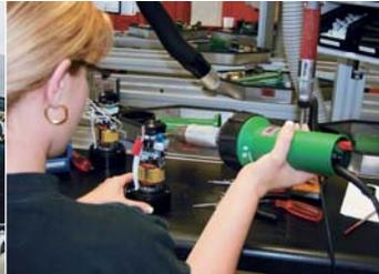
Rétraction d'une gaine thermorétractable avec le TRIAC PID.
