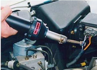
HOT JET S avec déflecteur de soudage lors d'une soudo-rétraction.
