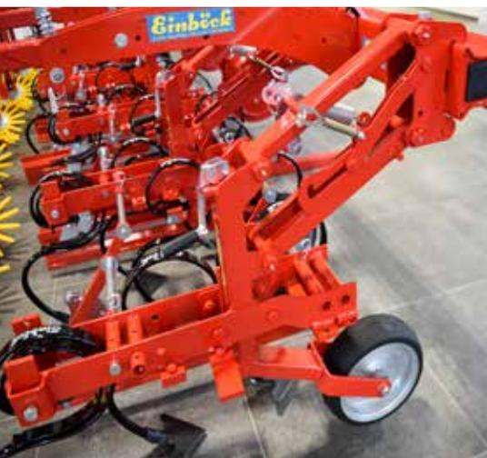
La **profondeur de travail** se règle de façon continue à travers une manivelle sur laquelle est montée une roue Farmflex. Un ressort muni d'un système de réglage permet de faciliter la pénétration du parallélogramme.
