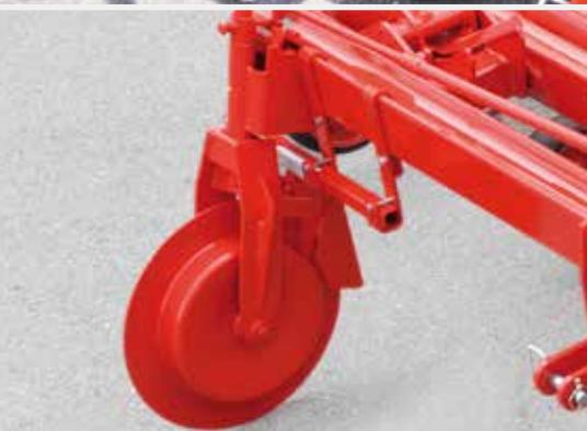
**Roue-coutres permettant** le guidage de la bineuse. Les roues avant du tracteur ne sont pas délestées.
