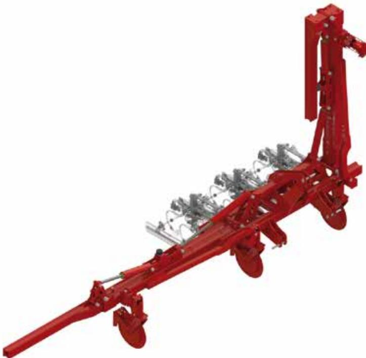
Châssis arrière avec repliage en portefeuille pour limiter la largeur de transport.
