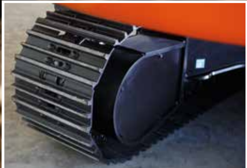
Le risque de dommages est réduit grâce à un capot de moteur renforcé.
