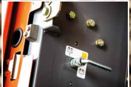
L'interrupteur a permis d'améliorer la sécurité pendant l'entretien.
