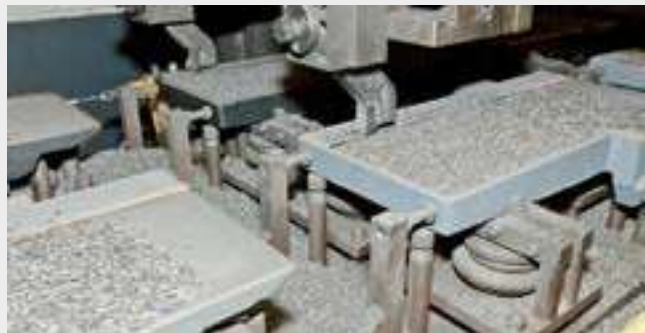
Rectification de tables en fonte
