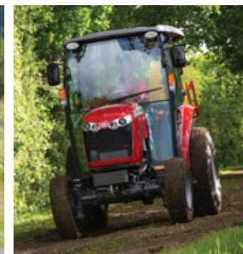
Un gabarit compact n'induit pas toujours un compromis sur la performance et la polyvalence. Motorisé par un puissant moteur à 4 cylindres associé soit à une transmission mécanique (A) ou à une transmission hydrostatique (HC), le MF 1747 est disponible en version plateforme ou cabine. Quelle que soit la configuration il offrira à votre activité un haut niveau de productivité.
