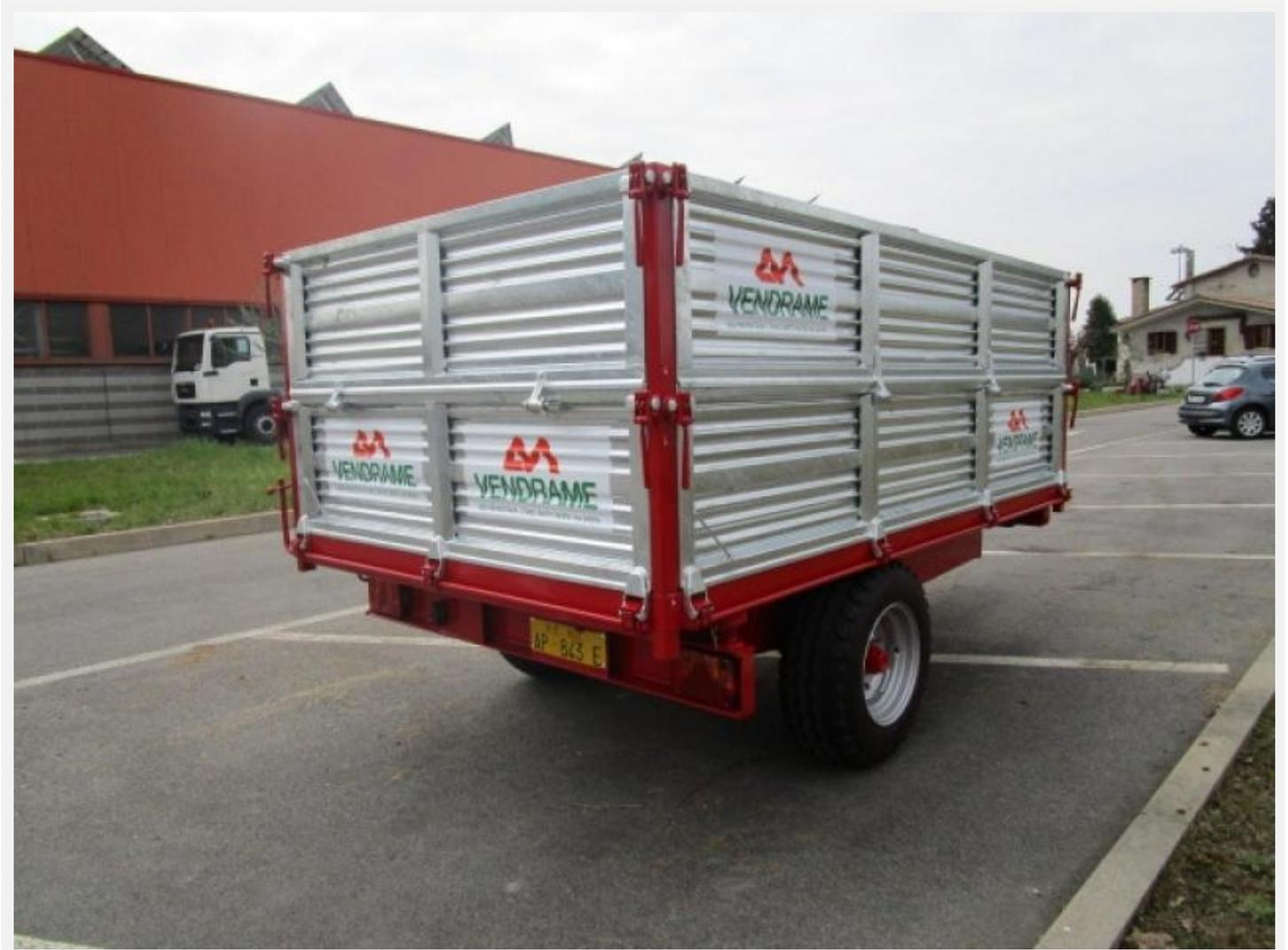
Remorque rabattable trilatérale, PTAC 50 quintaux, homologation routière, doubles ridelles zinguées h. 100 cm, ouverture haut et bas ridelle postérieure + latérale, plancher en tôle striée. Béquille manuelle, freinage hydraulique, pneumatiques 10.0/75-15.3. Mesures caisse cm 180x300.
