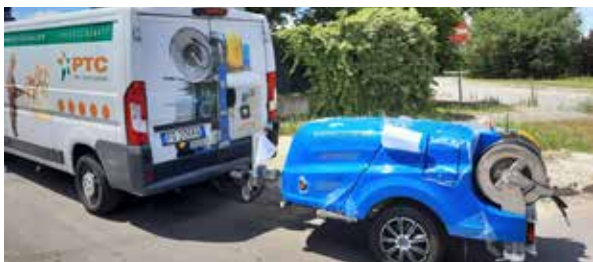
Version «PLUS», guide de flexible inclinable manuel, flexible haute pression et radiocommande
