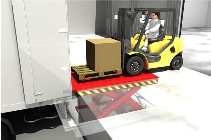
La PowerLift 740 est une table élévatrice à ciseaux hydraulique destinée pour le chargement et le déchargement de marchandises. Le concept modulaire de la table élévatrice permet de l'adapter à un très grand nombre de situations aussi bien pour les dimensions que pour la capacité utile.
